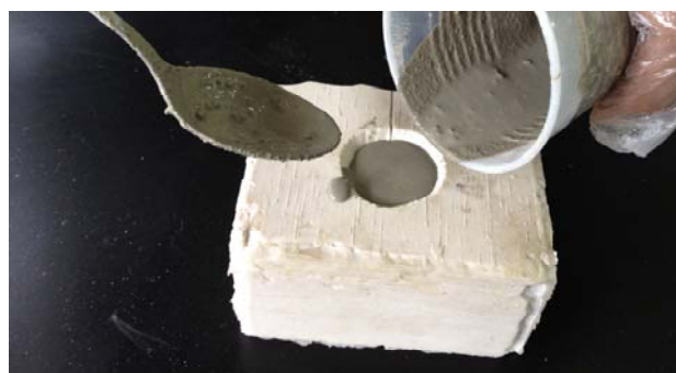
事前に準備したシリコンゴムの型に超速硬コンクリートを流し込みます。
