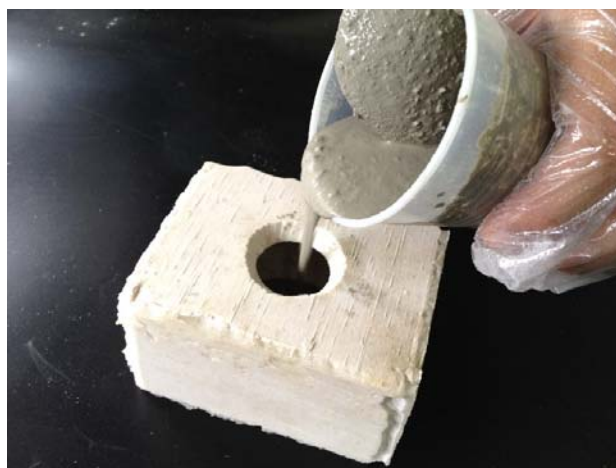
事前に準備したシリコンゴムの型に超速硬コンクリートを流し込みます。
