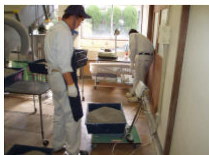
求めた割合に基づいて、各種試験に必要な分量を調合する
